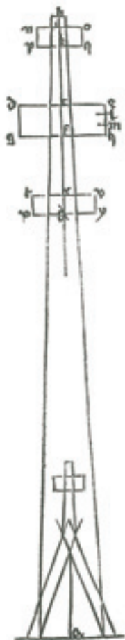
Zeichnung einer Fiale, aus Roritzers „Von der Fialen Gerechtigkeit“
